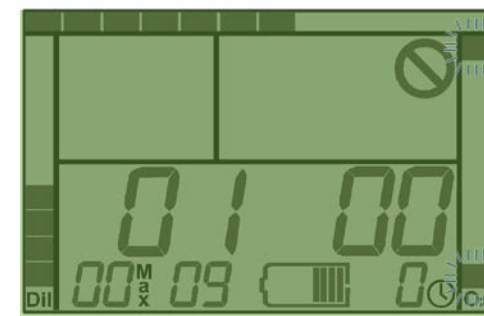
Rysunek 2-3. Kiedy dolny i górny segment na wyświetlaczu zacznie migać, ponownie zewrzyj mokre kontakty.
