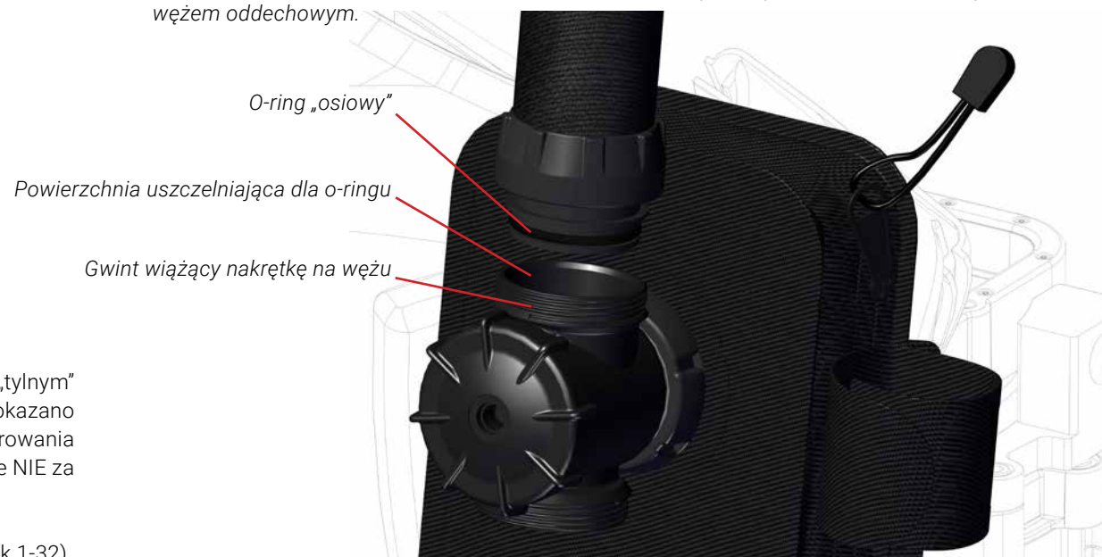
Rysunek 1-32. Połącz lewy tylny wąż oddechowy z lewym portem naramiennym.
