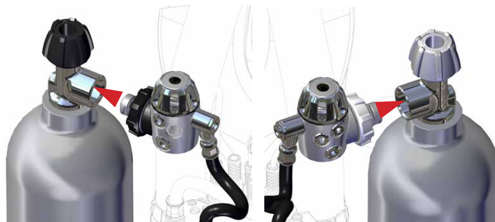
Rysunek 1-39. Włóż złącze automatu oddechowego diluentu do gniazda zaworu butli. Dociskając automat do zaworu, palcami wkręć złącze w zawór do oporu.
