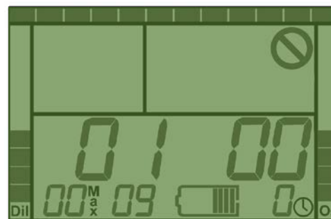
Rysunek 2-2. Ekran podczas pierwszych pięciu sekund od włączenia pokazuje wersję firmware'u i numer seryjny.
