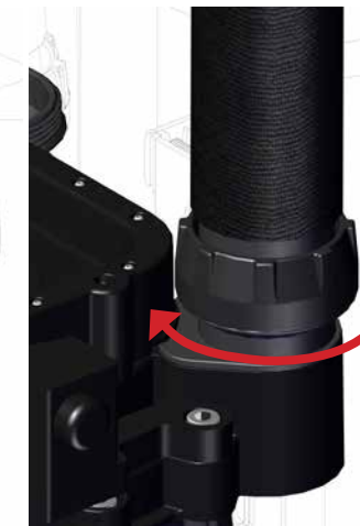
Rysunek 1-30. Dokręć nakrętkę palcami: NIE używaj narzędzi, nie dokręcaj zbyt mocno.
