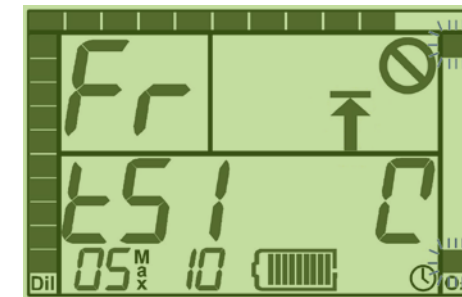
Rysunek A2-8: Ekran potwierdzający frakcję tlenu podczas testu 52, pokazujący kolejno wartości „O 2 ” (tlen), „Fr” (frakcja) i liczbę oznaczającą przypuszczalną frakcję tlenu w diluencji.
