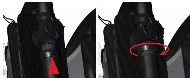
Rysunek 1-48. Dokręć palcami (w prawo) nakrętki na przednich wężach oddechowych do przednich portów naramiennych. NIE używaj narzędzi.
