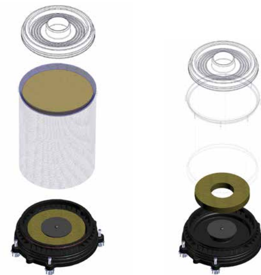
Rysunek 1-61. Podnieś i wyjmij dolną gąbkę; sprawdź, czy nie nasiąkła wodą. Wypłucz, wysusz i włóż gąbkę na miejsce; zdezynfekuj gąbkę, jeśli to konieczne.
