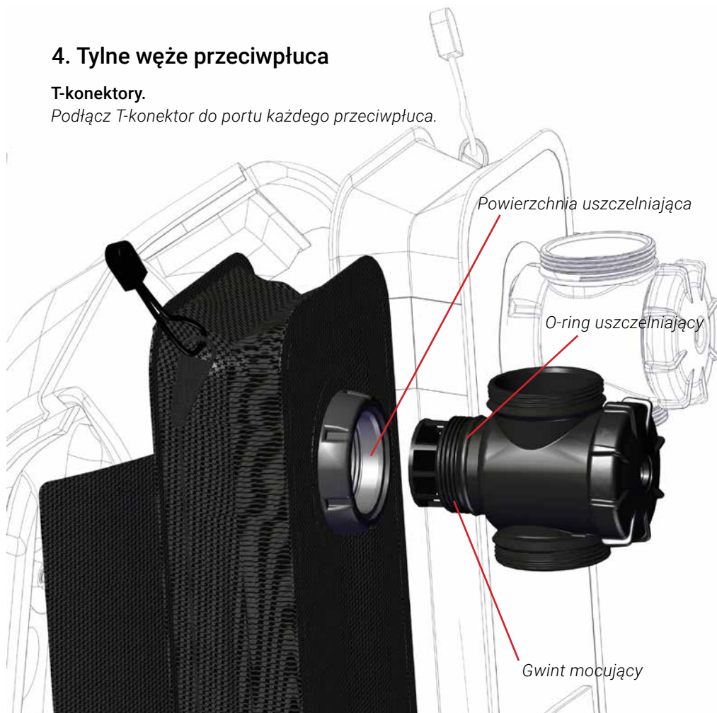
Rysunek 1-23. Umieść prawy kolektor pułapki wodnej w porcie prawego przeciwpłuka.
