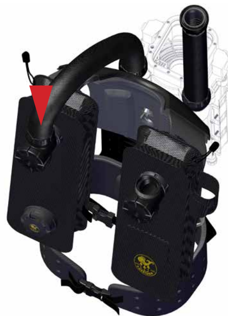
Rysunek 1-31. Połącz kolektor pułapki wodnej prawego przeciwpłuca z prawym tylnym węzem oddechowym.
