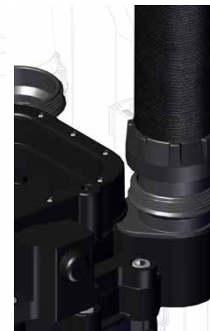
Rysunek 1-29. Włóż koniec węży w gniazdo, aż zewnętrzny kołnierz zrówna się z początkiem gwintu.
