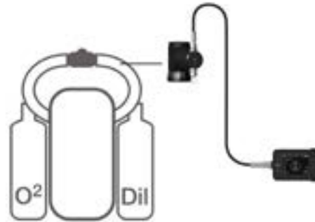
Konfiguracja pętli tlenowej dla dowolnego rebreathera (CPOD + M28)
